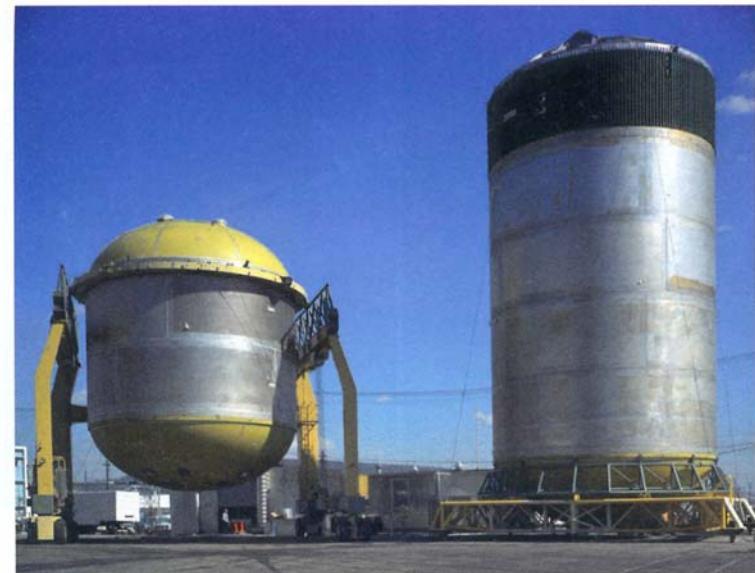
Abb. 9.10: Die beiden Treibstofftanks der S-IC-Stufe in unmontiertem Zustand
