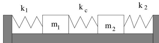
Leiten Sie daraus die Bewegungsgleichungen für die Position  $x_{1,2}$  und Geschwindigkeiten  $v_{1,2}$  her. Drücken Sie diese in Abhängigkeit von  $\Delta t$  ab und lösen Sie die Bewegungsgleichungen *numerisch* mittels *Mathematica*, indem Sie zunächst  $v_{1,2}$  und dann daraus  $x_{1,2}$  für kleine Zeiträume  $\Delta t$  berechnen lassen. Hinweis: Verwenden Sie einen Do-Loop.
