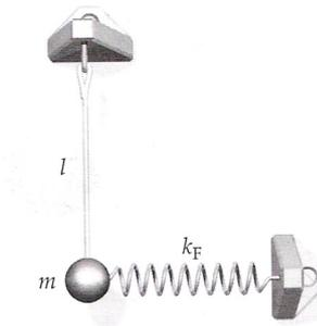
Der Pendelkörper ist an einer horizontalen Feder mit der Federkonstanten  $k_F$  befestigt. Wenn sich der Pendelkörper direkt unter der Aufhängung befindet, hat die Feder ihre Gleichgewichtslänge.
