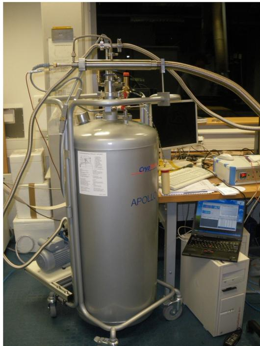
Abbildung 3.5: Foto der Kaltgasanlage: Das Dewar-Gefäß auf einem Rollgestell mit Vakuumpumpe, eingetauchtem Jet und auf dem Dewar-Gefäß befestigtem Heater. Das Kontrollgerät befindet sich rechts auf dem Tisch und kann zusätzlich über den Laptop gesteuert werden.
