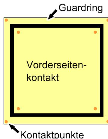
Abb. 6.2: Schematische Darstellung der Vorderseite eines CdTe-Detektors
