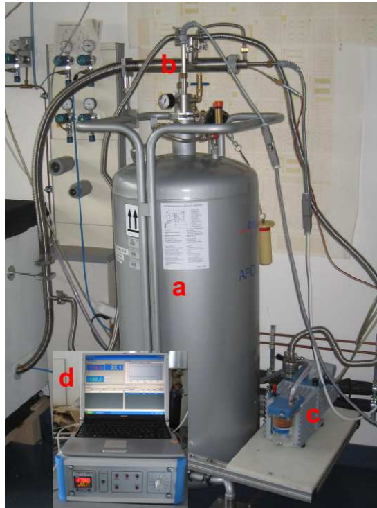
Abbildung 4.4: Die Kaltgasanlage. Der Stickstofftank ist auf ein Rollgestell montiert und über vakuumevakuierte Welschläuche mit der Kühltruhe verbunden (links). a. Dewargefäß, b. Heater, c. Vakuumpumpe, d. Steuereinheit mit PC
