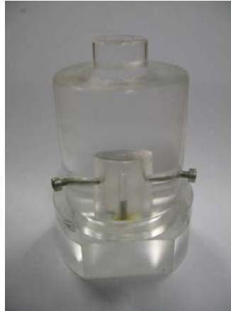
Abbildung 4.8: Quellenhalterung aus Plexiglas, hier die ^{90}\text{Sr} -Quelle mit 37 MBq. Unten der abnehmbare Deckel.
