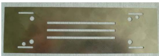
**Abbildung 5.13.:** Erste Version der Freiburger Rakelmaske.
