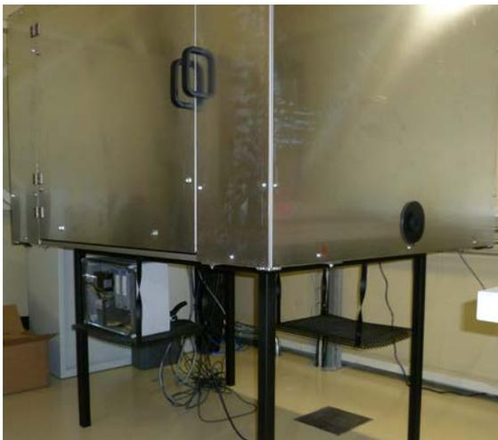
**Abbildung 6.24.:** Lichtdichte Box des CERN Teststand für ein *Stavelet*.
