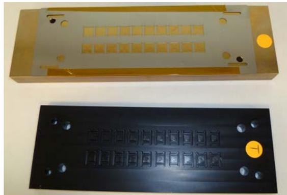
d) Chip Tray; Oben: mit Laser gefertigte Schablone auf Messingblock; Unten: aus ESD sicherem Kunststoff gefräst
