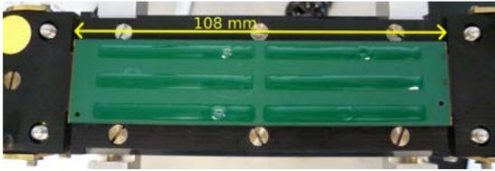
**Abbildung 5.15.:** Klebstoff wurde auf Hybridrückseite aufgetragen.
