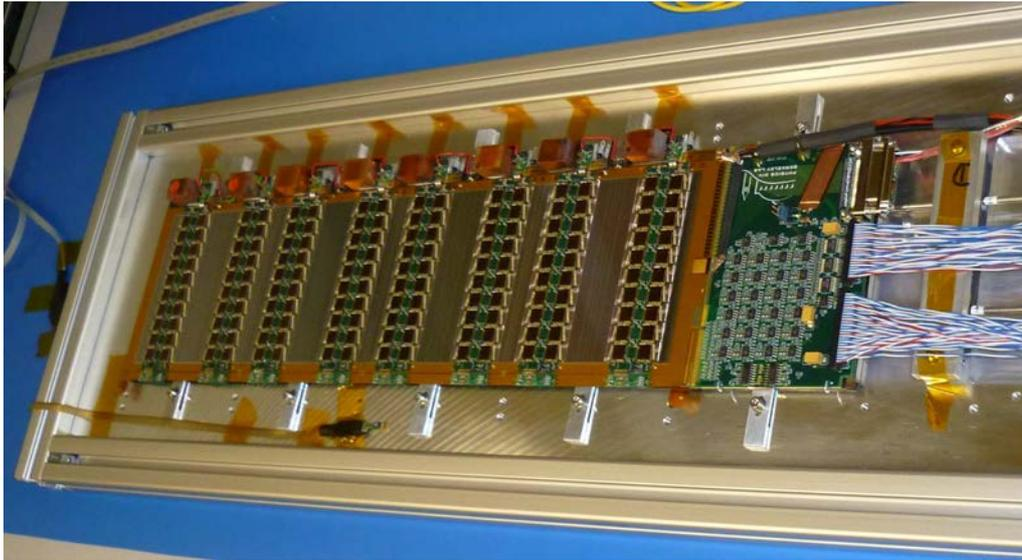
**Abbildung 6.23.:** DC-DC *Stavelet* in Aluminiumtransportbox: Ein aus vier Modulen aufgebautes *Stavelet*, dessen Module parallel geschaltet sind. Rechts neben den Modulen befindet sich die *End-of-Stave*-Karte, über die die Auslese und die Spannungsversorgung geregelt wird.
