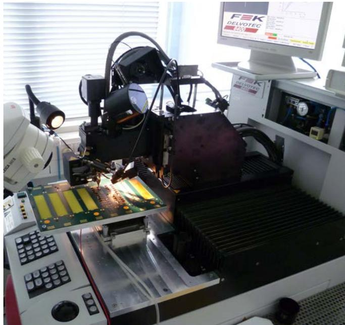
**Abbildung 5.20.:** Freiburger Bondmaschine: Delvotec 6400.
