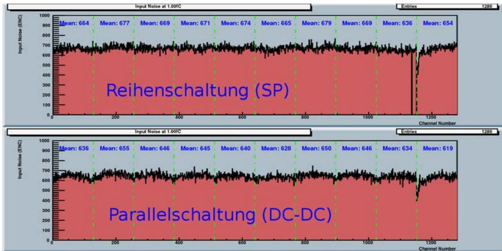
**Abbildung 6.8.:** Vergleich des Rauschens für zehn Auslesechips eines Moduls; Oben: *Module Serial Power Testing Frame*; Unten: DC-DC Rahmen mit geringerem Rauschen.
