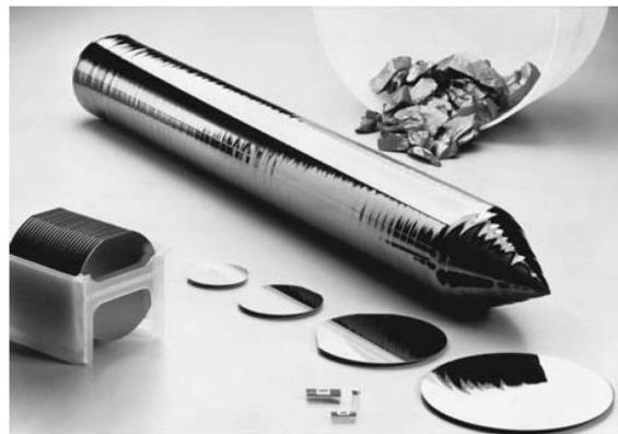
**Abbildung 2.6.:** Silizium Ingot und geschnittene Wafer [Har09].
