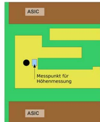
**Abbildung A.3.:** Detailansicht des Messpunkts auf dem Hybrid zur Bestimmung der Klebstoffhöhe zwischen Hybrid und Sensor.
