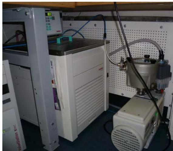
**Abbildung 4.3.:** HSIO-Auslesesystem: Ein Kühlaggregat (Julabo FP 50) für die Kühlung von Modulen (links) und die Vakuumpumpe (EDWARDS 5 Vacuum Pump) zum Fixieren der Testobjekte (rechts).
