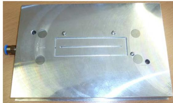
f) *Hybrid Assembly and Test Jig* für Bestückung der Hybride mit Auslesechips
