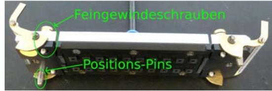
**Abbildung 5.7.:** Positions-Pins und Feingewindeschrauben an *Pickup Tool*.
