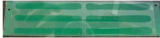
**Abbildung 5.16.:** Klebstoffverteilung nach dem Kleben eines Hybrids auf einen Glassensor.
