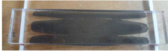
**Abbildung 5.2.:** Klebetest mit Plexiglasattrappen und eingefärbtem Araldit.
