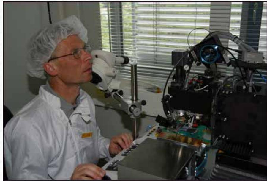
Bau von Siliziumstreifendetektoren in Freiburg (2005) zur Vermessung der Spurpunkte ( $\rightarrow$  Impuls) von elektrisch geladenen Teilchen
