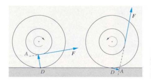
Relative Lage von Drehpunkt D und Angriffspunkt A der Kraft bei der folgsamen (links) und unfolgsamen Garnrolle (rechts)
